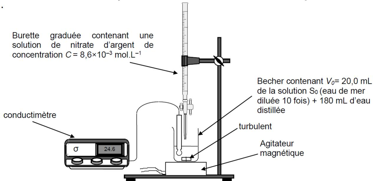
*Rq : nous avons remplacé l'erenmeyer mentionné dans l'énoncé par un bécher, beaucoup plus adapté pour laisser passer la sonde du conductimètre.*
